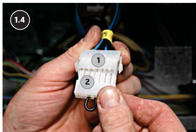
Fjern kontakten (2) fra ledningssettet (1) i aggregatet.
